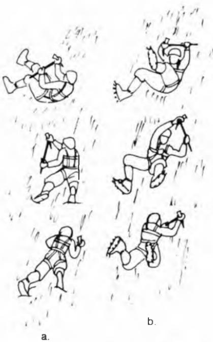
Sl. 172. Padovi — poskliznuća na snježnim padinama i načini zaustavljanja: a. meki snijeg (pad na bok), b. tvrdi snijeg (pad na leđa s glavom gore), c. tvrdi snijeg (pad na prsa s glavom dolje)
