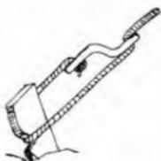
Sl. 2. Pločica za napinjanje uzice šatora
